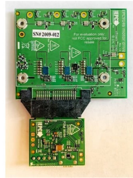
图 8: 基于 EPC2152 单片功率级构建的三相 BLDC 电机驱动
